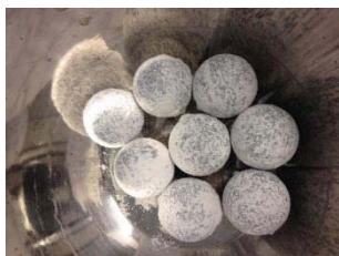
4. ábra: Mészkő őrlése – jelentős feltapadás
