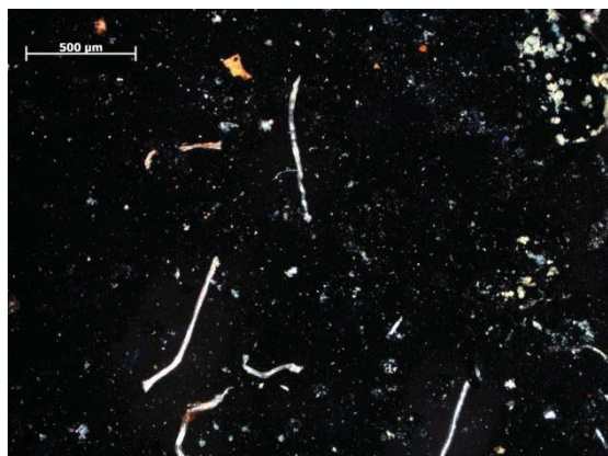
6. ábra: Flotálás 1 perces habterméke 10-es pH-n
