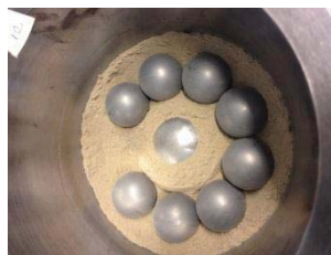
5. ábra: Kvarc őrlése – nincs feltapadás
