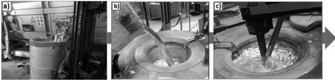
3. ábra: Folyékony fém előkészítésének folyamata
