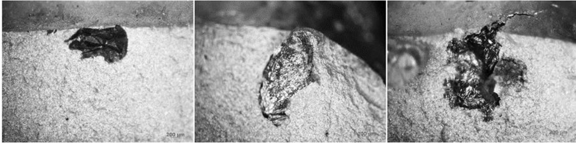
6. ábra: K-próbák töretfelületein talált zárványok
