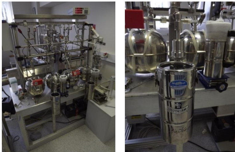
3. ábra: A vákuum-desztillációs rendszer felépítése.
