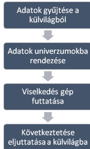
5. ábra: Beágyazott rendszer szoftverének működése
