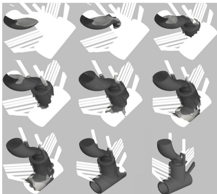
6. ábra: Az öntvény formatelésének folyamata
