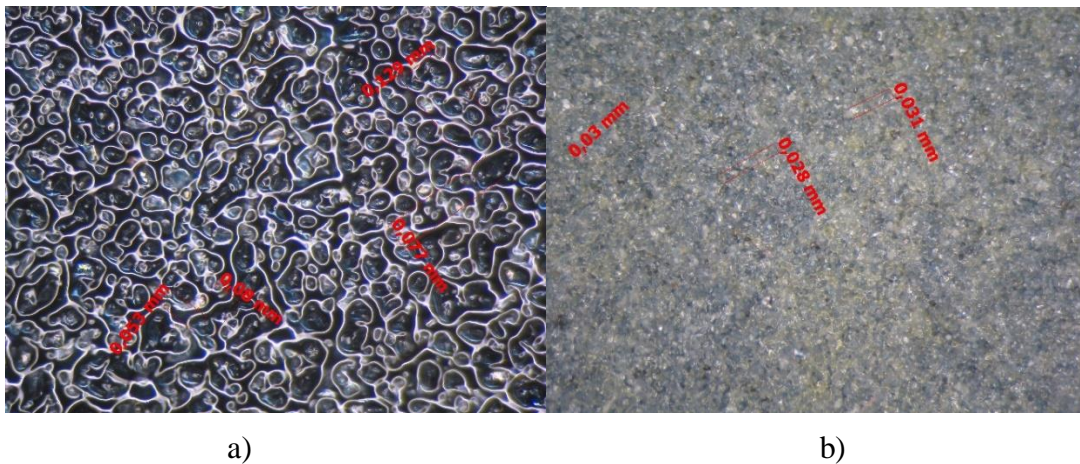
7. ábra: a) P400 csiszolópapír 100x nagyításban, b) P1200 csiszolópapír 100x nagyításban
