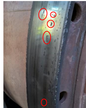
1. ábra: Dobkemence (balra), illetve a dobkemence futógyűrűje közelről (jobbra). Utóbbin pirossal a felületi kifáradás jeleit, a foltokban megjelenő anyagvesztés jeleit néhány példával.
