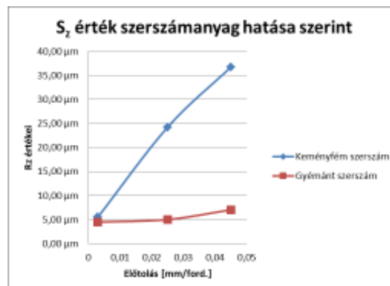
5. ábra: S_z érték szerszámanyag hatása szerint
