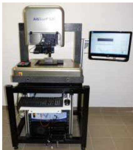
3. ábra: AltiSurf 520 háromdimenziós felülettopográfiai berendezés
