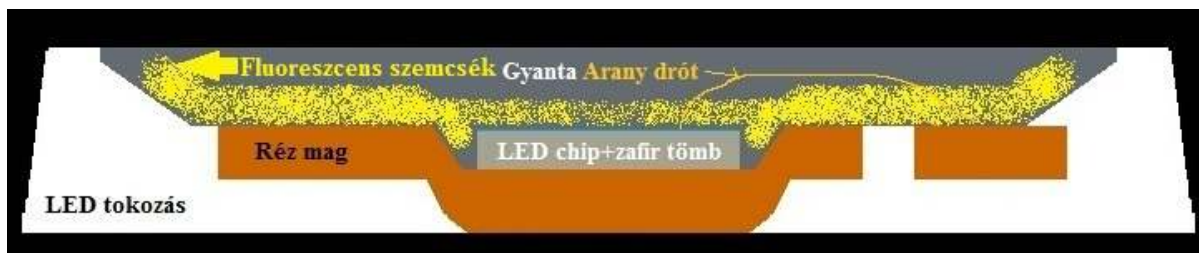
3. ábra: SMD LED felépítése
