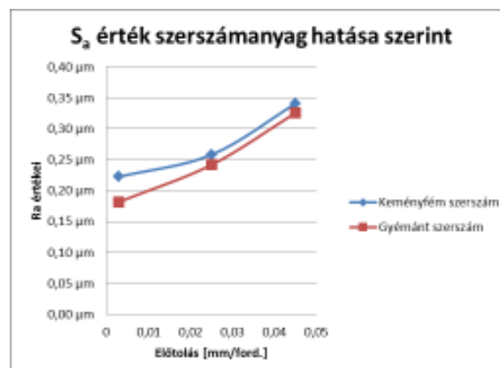
6. ábra: S_a érték szerszámanyag hatása szerint
