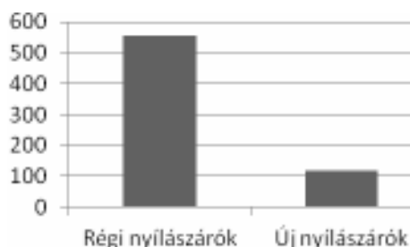
2. ábra: Hőveszteségek alakulása új nyílászárók esetén [W]
