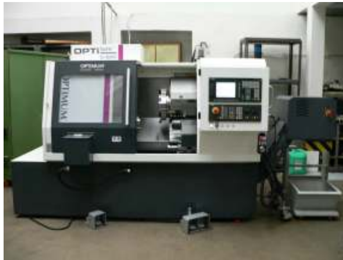
1. ábra: OPTIturn S600 CNC esztergagép
