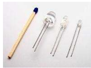
2. ábra: LED-ek (DIP LED) különböző méretben, balról jobbra: 8, 5, 3 mm-es fejtátmérővel balról (összehasonlításképpen egy gyufaszál)
