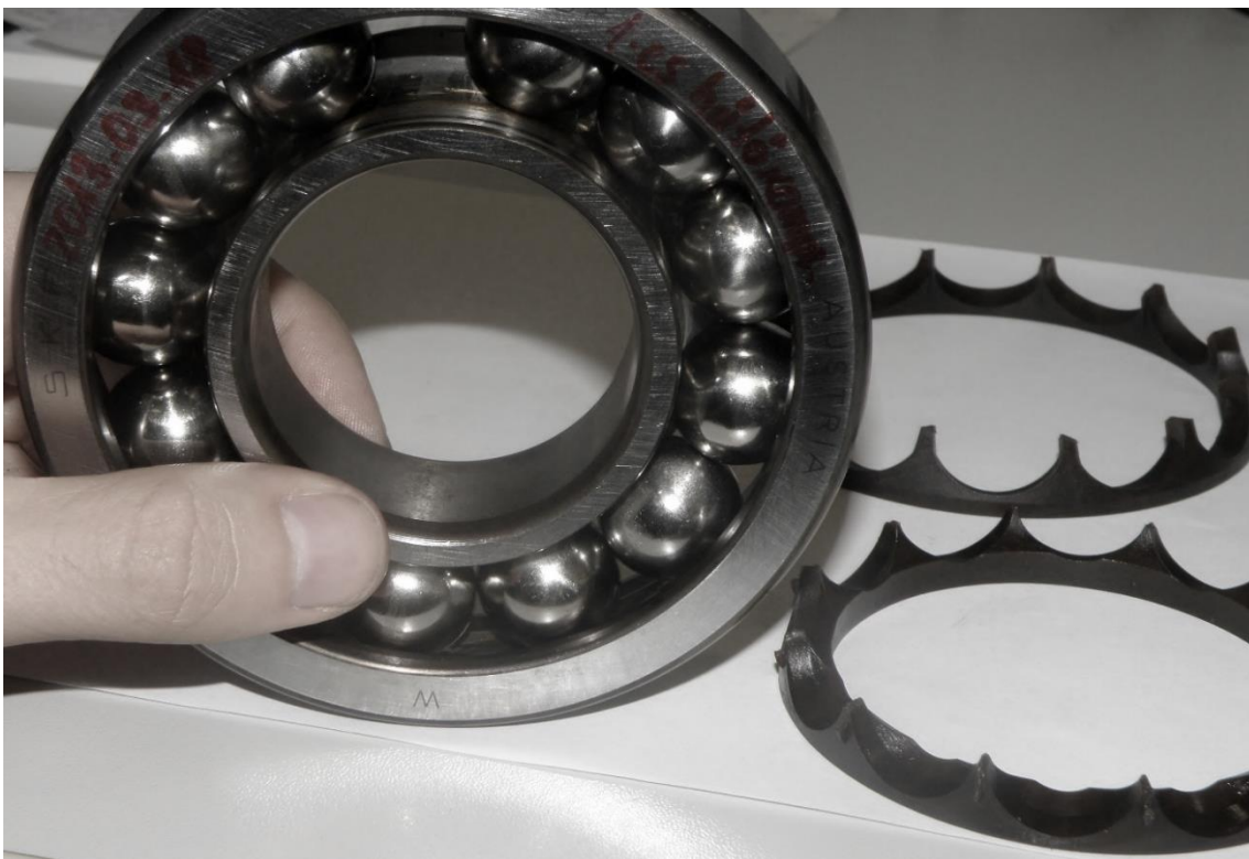
4. ábra: Sérült csapágy a kiszerelés után
