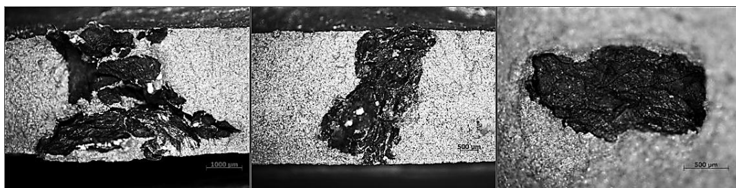
5. ábra: K-próbák töretfelületein talált zárványok
