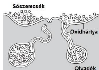
11. ábra: Sószemcsék adagolásakor lejátszódó bifilm képződési mechanizmus [16]
