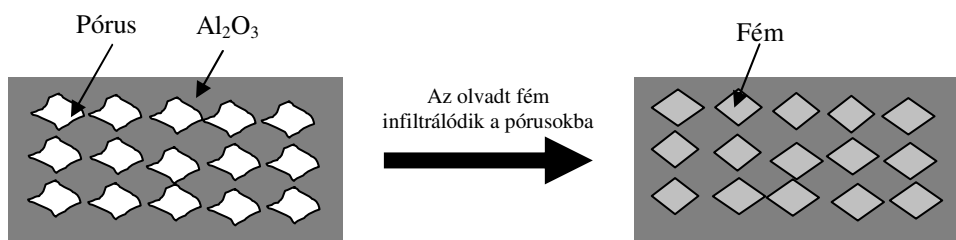
2. ábra: Kompozit anyag készítése
