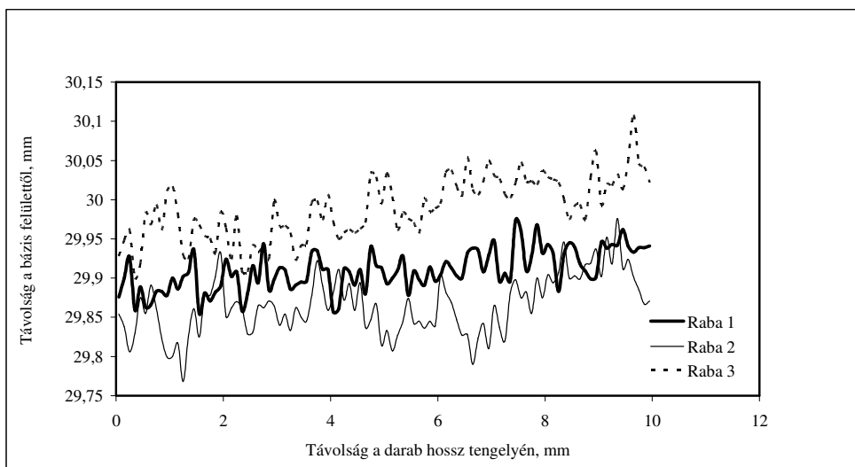
2. ábra: Szemcseszórásst követő felületi érdesség
